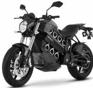
Moto elettrica (Brammo-Empulse R); può raggiungere i 160 km/h e possiede un'autonomia di 160 km.
